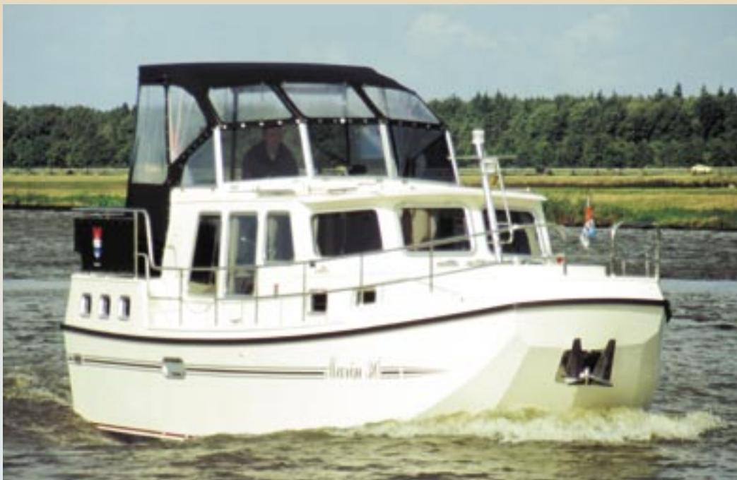
De Marin heeft een stompe boeg, die lijkt op die van een Doerak of een Marineschouw.
