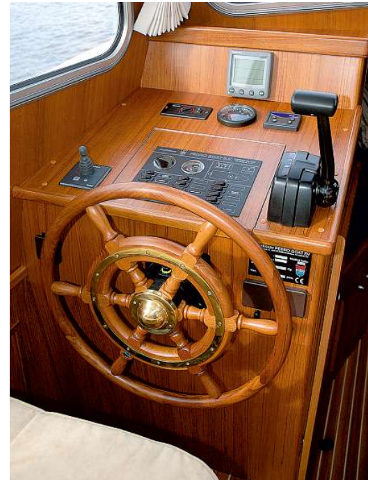
Übersichtlicher Steuerstand: Zwischen den Lenkanschlägen liegen vier Ruderdrehungen
