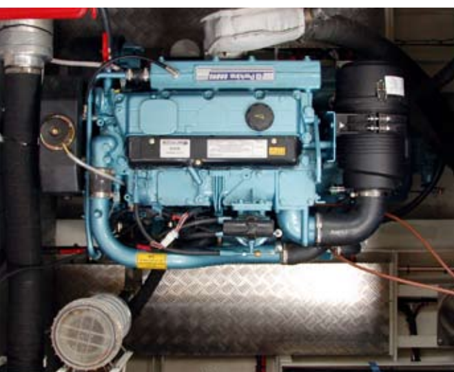
Boven: Het vele teak in het interieur is perfect afgewerkt, wat een rijke uitstraling geeft. Midden: Natte cel. Onder: De Levanto 32' wordt standaard uitgerust met een Perkins M92B dieselmotor van 86 pk bij 2400 toeren per minuut.
